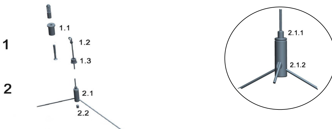
Рис. 2: Подвес из стальных тросиков, aquafit 3
